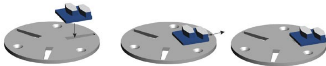
Figur 4-4 Hur man fäster slipsegmenten på Scan-On-fästskivan
