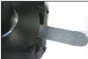
Par l'ouverture du capot de protection, vous pouvez maintenant maintenir le disque moteur entre la boîte de vitesse et la meule avec la clé à mâchoire 32 livrée avec le produit.
