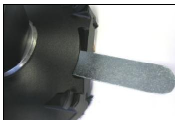
Nu kan man gennem åbningen i skærmen (ved hjælp af den vedlagte SW 32 nøgle) holde igen mellem på flanche skiven mellem Motoren og diamantslibeskiven.
