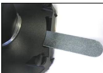
Houd de aandrijfschijf, door de opening aan de beschermkap, tussen de tandwielaanpassing en het slijpwiel vast met gebruik van de meegeleverde 32 verstelbare moersleutel.
