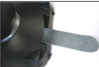
Nun kann durch die Öffnung an der Schutzaube mit dem im Lieferumfang enthaltenen Maulschlüssel SW 32 die Flanschscheibe zwischen Getriebe und Schleifscheibe gehalten werden.
