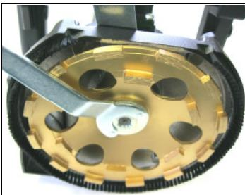
Mit dem Stiftlochschlüssel kann die Mitnahmemutter gelöst werden. Danach kann die montierte Schleifscheibe entfernt bzw. die neue montiert werden.
